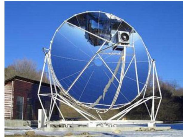
Figure 45 : Collecteur parabolique<sup>280</sup>
