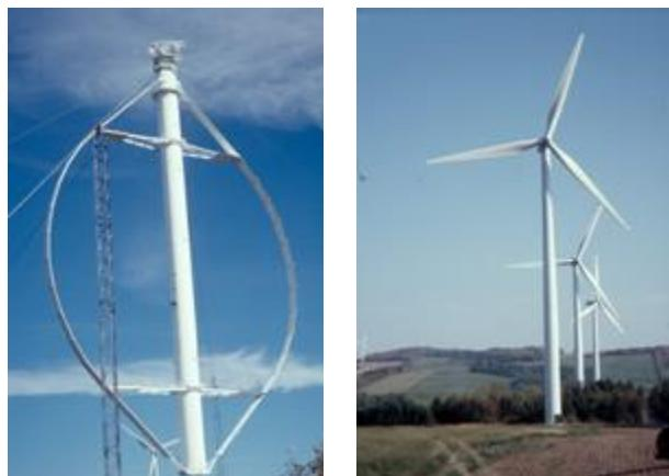
Figure 32 : Éolienne à axe vertical (à gauche) et à axe horizontal (à droite)<sup>211</sup>
