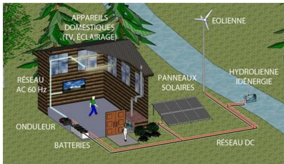
Figure 27 : Exemple de résidence autonome en alimentation électrique.<sup>189</sup>
