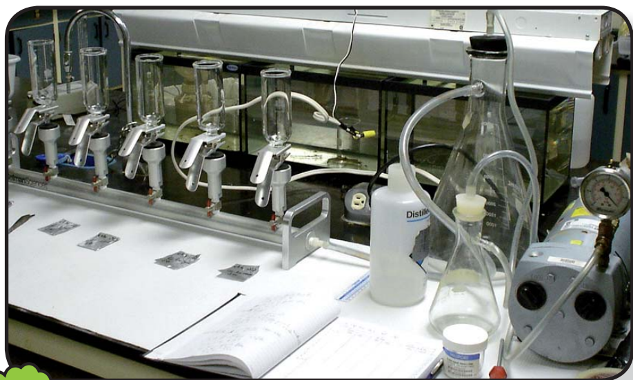
Tours de filtration utilisées pour récolter de la chlorophylle a sur un filtre.
