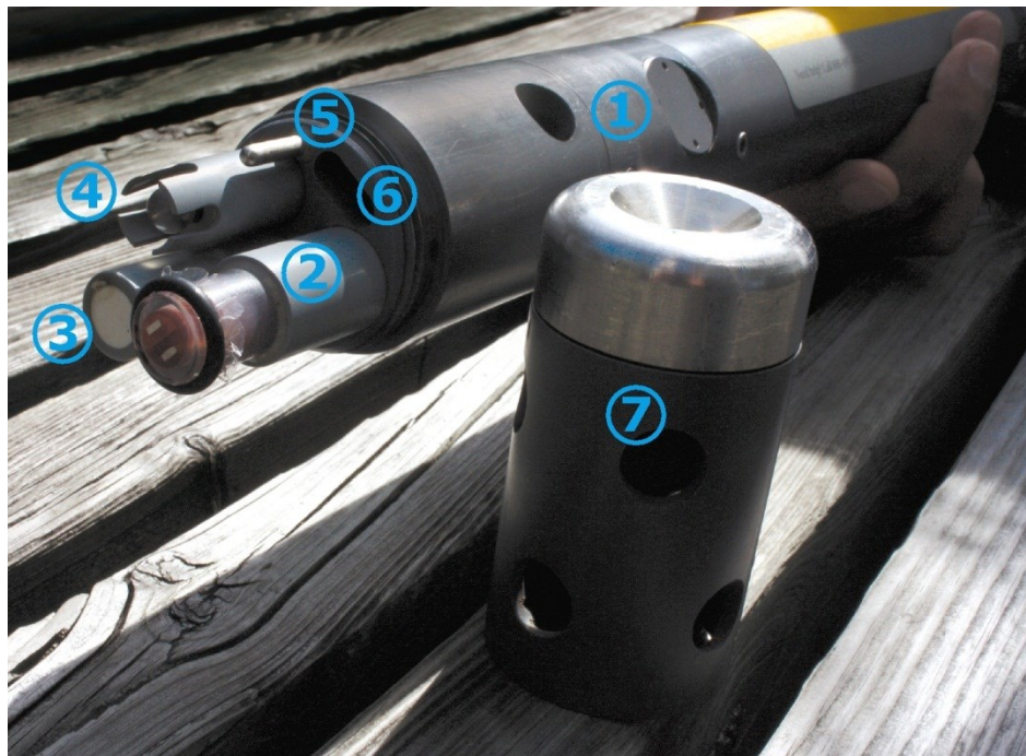
Figure 3. Les différents capteurs de la sonde multi-paramètres © CRE Laurentides
